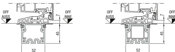
Bei Pfostenkonstruktionen mit eingeschobener durchgehender Rohrverstärkung
