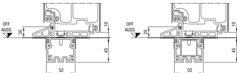
Bei Pfostenkonstruktionen mit eingeschobener durchgehender Rohrverstärkung
