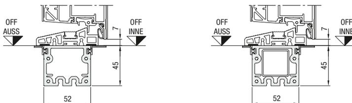
Bei Pfostenkonstruktionen mit eingeschobener durchgehender Rohrverstärkung
