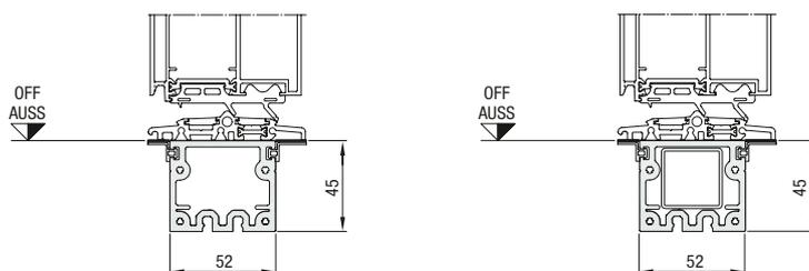
Bei Pfostenkonstruktionen mit eingeschobener durchgehender Rohrverstärkung
